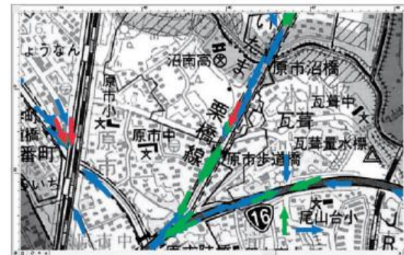
図.急ブレーキ発生個所データからの発生地点の分析結果 （矢印の方向が車両進行方向、矢印の先端が発生地点）
